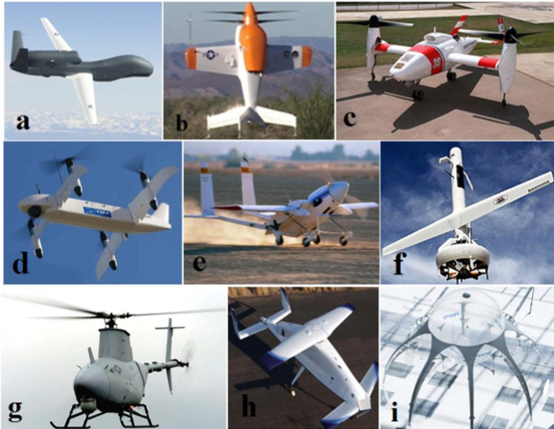
Σχήμα 1: Διαφορετικοί τύποι UAVs, (a) HTOL – οριζόντιας απο-προσγείωσης, (b) VTOL – κατακόρυφης απο-προσγείωσης, (c) ανακλινόμενου ρότορα, (d) ανακλινόμενου πτερυγίου, (e) ανακλινόμενου σώματος, (f) τύπου ‘ανεμιστήρα’, (g) ελικοφόρα, (h-i) μη συμβατικά UAVs [13].
