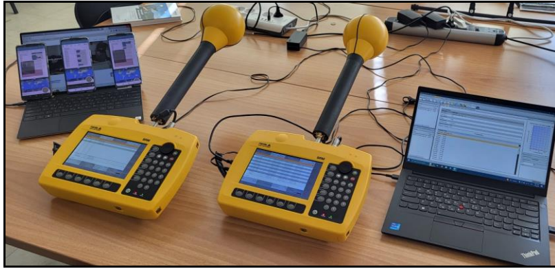
Εικόνα 7: Εργαστηριακό test δύο SRM3006 σε συνδυασμό με την λειτουργία τριών τερματικών κινητής που είναι συνδεδεμένα σε 2G, 4G και 5G.
