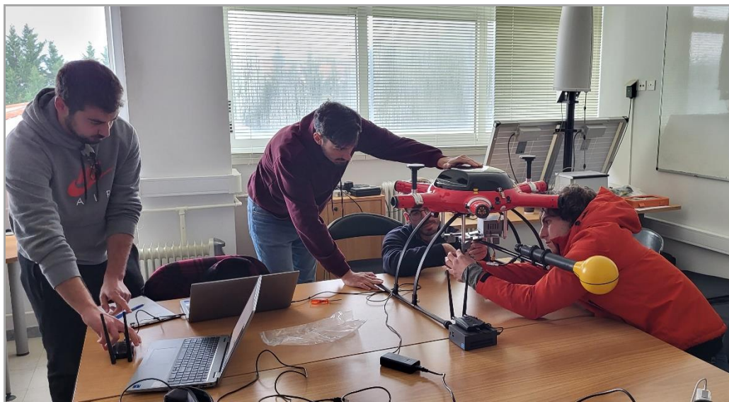
Εικόνα 9: Στήριξη του SRM-3006 στο drone
